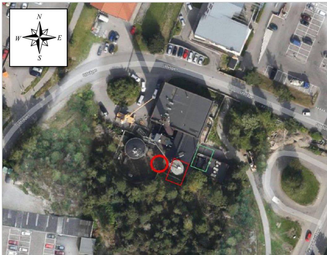
Figur 6. Utbyggnad av Orminge panncentral. Grön markering (rektangel) är huvudalternativ med nuvarande tomtgränser. Röd markering innebär utbyggnad söderut efter genomfört markbyte, där rektangel är utbyggnaden och röd cirkel är flytt av befintlig pelletssilo. [2]
